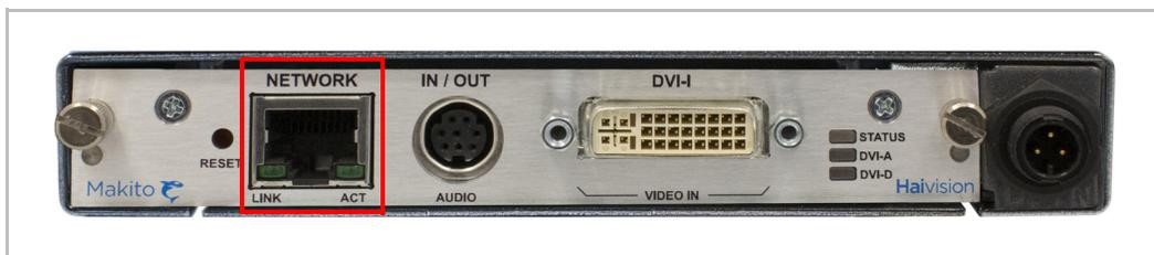
在带有 SDI 的 Makito X 上，计算机可通过其 RJ45 连接器连接到 COM1 RS-232 串行端口（需要串行管理适配器，请参见第 26 页上的“[串行管理适配器](#)”）。
