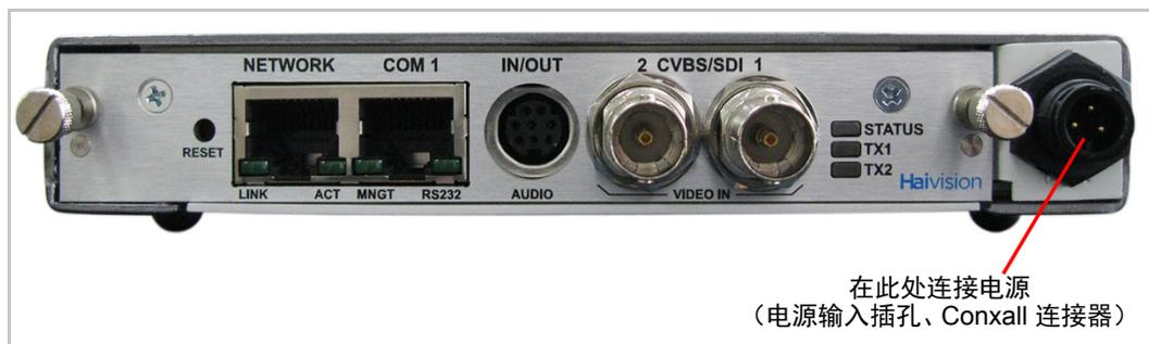
图 2-11 带 Conxall 连接器的单高机壳电源适配器 12VDC
