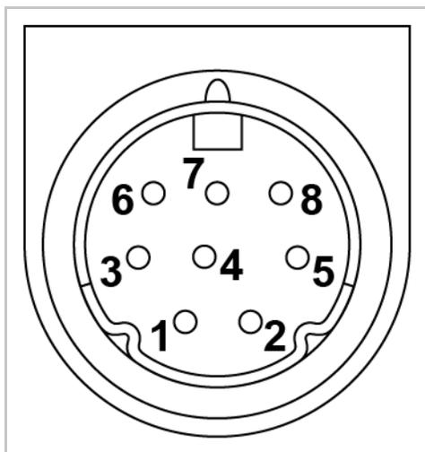
表 2-2 微型 DIN-8 音频连接器针脚分配
