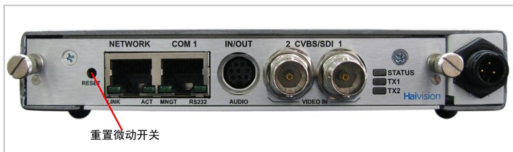
2. **电源重置：**对于电源重置，请按下微动开关（您将感觉到按钮压下）至少一秒然后松开。确保在五 (5) 秒内松开按钮。
