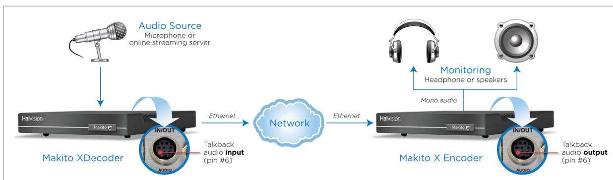
Makito X 上没有音频混音器，因此对讲功能是“先入先得”的，这意味着，一次仅允许一个用户使用音频回传通道。InStream 播放器应用程序提供“一键对讲”功能，这要求用户按下按键来传输音频。用户必须按住按键才能使用对讲通道。这可防止用户意外锁定和不释放通道。
