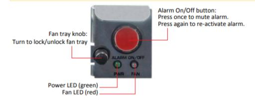
To replace the MB6 Chassis fan tray:
