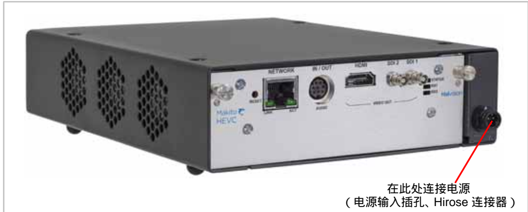
图 2-12 显示了 3 针 Hirose 锁定电源连接器的双高机壳
