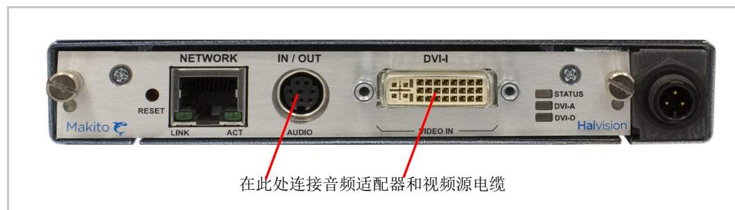
图 2-4 DVI-I 输入连接 (#S/B-292E-DVI)
