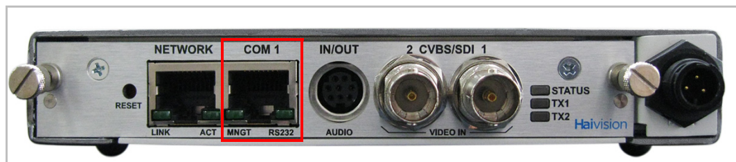
图 1-10 串行连接（SDI、双通道 #B-292E-HDSDI2）
