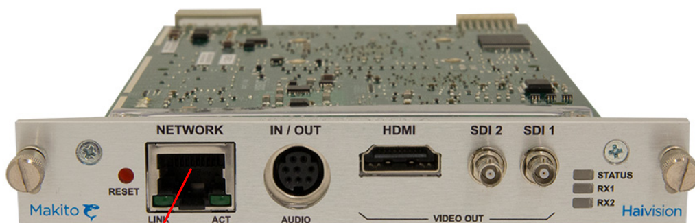
图 2-1 网络连接器（双通道解码器，#S-292D-HD2）
